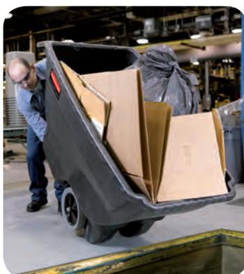
Идеальный баланс веса и дополнительная ручка внизу контейнера, позволяет работнику без усилий опрокинуть его вперед для того, чтобы выбросить содержимое.
